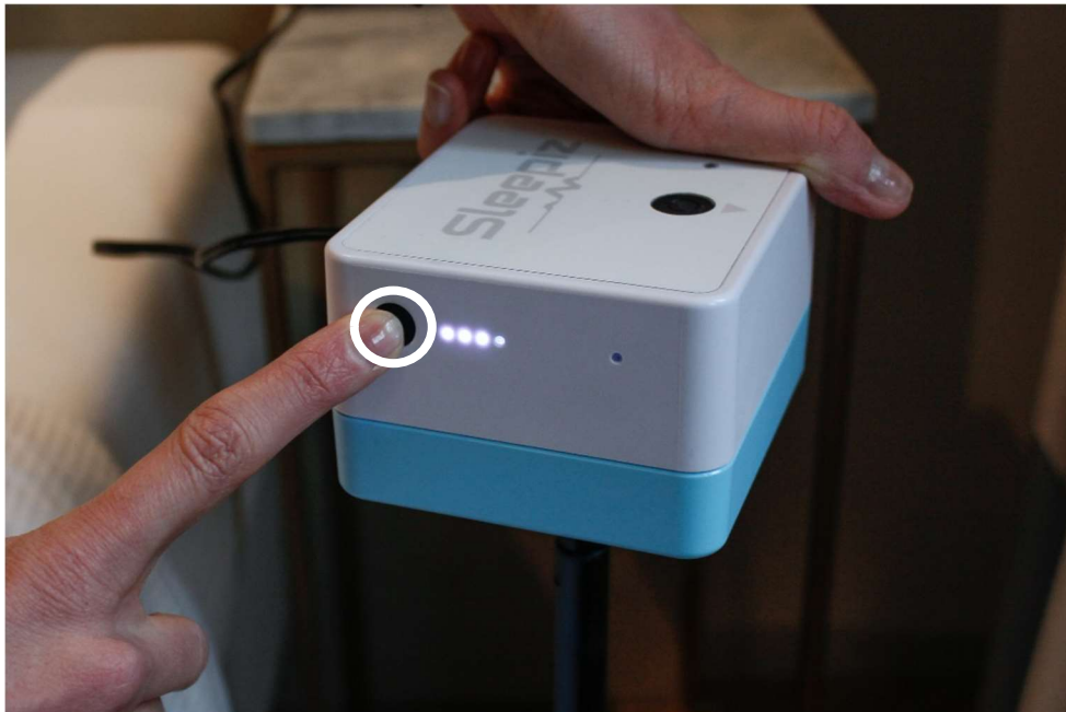
Abbildung 12. Die Batteriestatus Taste ist umkreist. Neben der Taste befinden sich 4 Batteriestatusanzeigen. Wenn die Batterie ausreichend geladen ist für die Datenaufnahme für 8h, werden nach Betätigung der Batteriestatus Taste mindestens zwei von vier Batteriestatusanzeigen aufleuchten.
